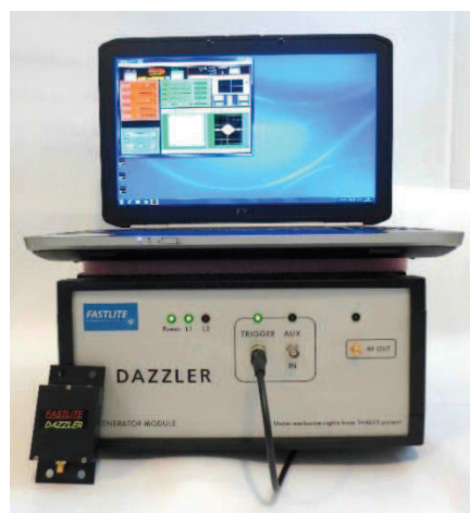
Figure 2.11 : Dazzler™ : modulateur acousto-optique programmable (AOPDF) qui permet une modulation en amplitude et en phase du spectre.
