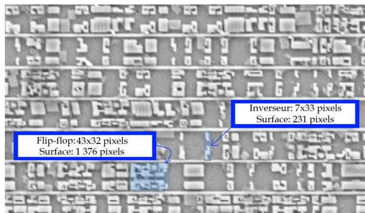
FIGURE 2.16: Couverture en pixels d'un inverseur et d'une flip-flop sur le circuit N.1
