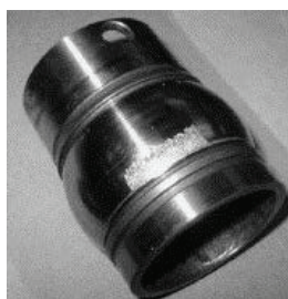
Figure 4. 41. Défaut de bague interne dans le roulement 3
