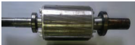
(a) vieillissement des roulements
