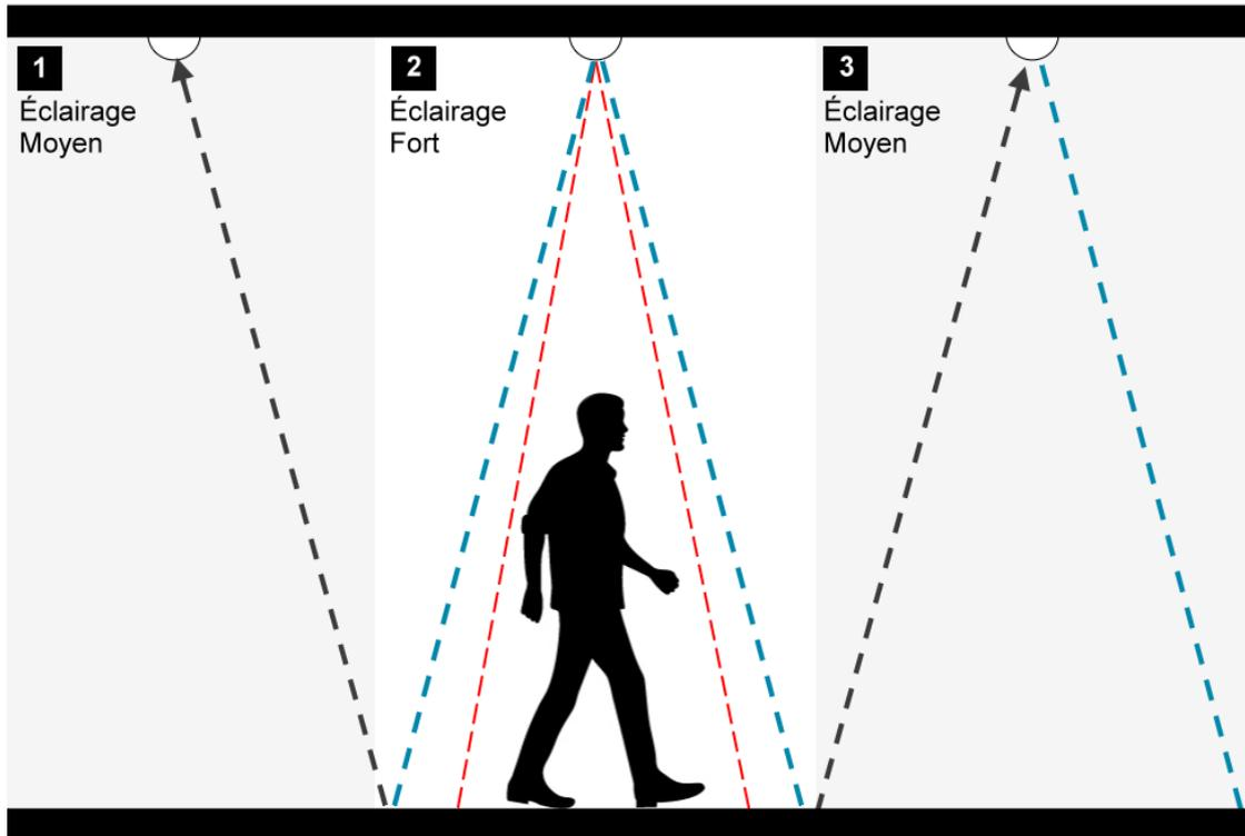
FIGURE 4.19 – Éclairage intelligent en fonction du mouvement
