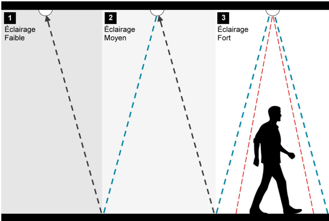
FIGURE 4.23 – Éclairage intelligent en fonction du mouvement continu
