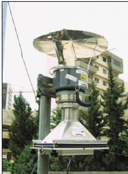
Figure II-4 : Photo d'un impacteur en cascade STAPLEX® 236.
