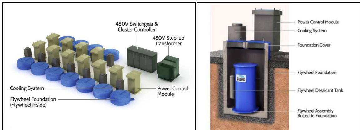
**Figure 32 : Structure d'une centrale inertielle Beacon Power [32]**
