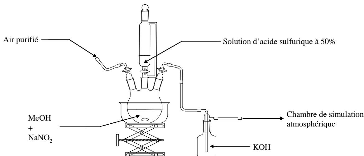
Figure III.1. Schéma du montage pour la synthèse du CH<sub>3</sub>ONO.
