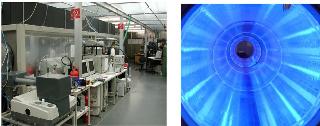
Figure IV.2. Photographies de la chambre de simulation atmosphérique de 1080 L de l'Université de Wuppertal (l'extérieur, à gauche et l'intérieur, à droite).
