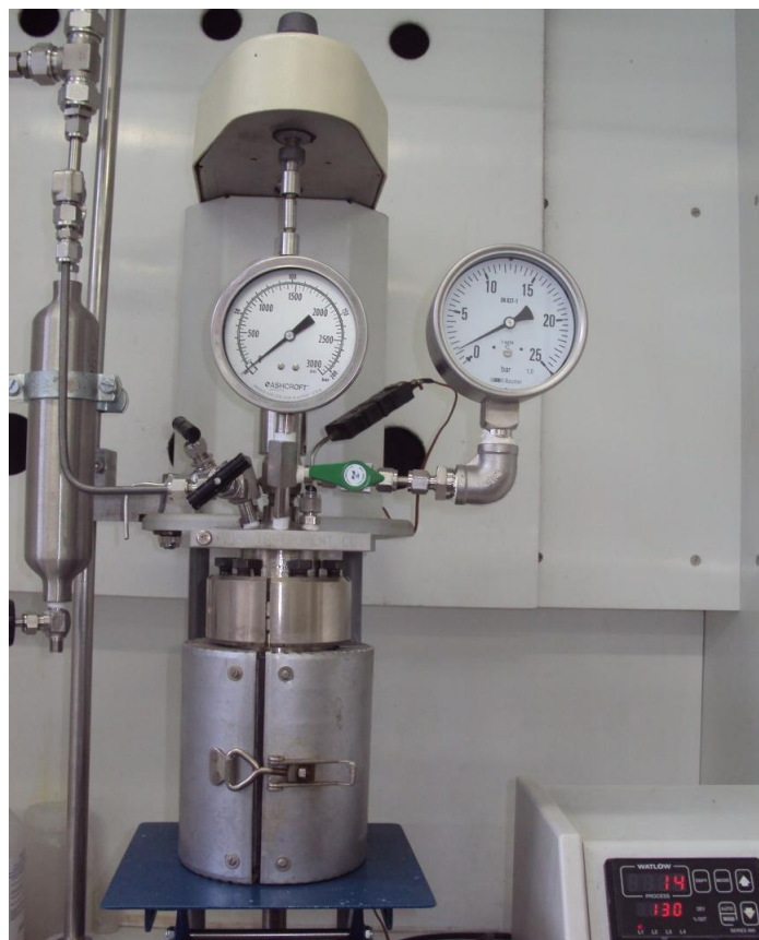
Figure 13. Montage du réacteur utilisé pour l'oxypropylation de la lignine
