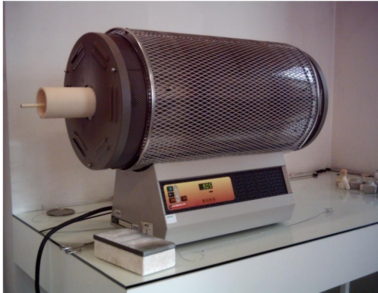
Figure 6 : Représentation schématique du four tubulaire utilisé pour la pyrolyse
