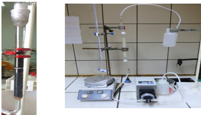
Figure 8. Montage d'adsorption par colonne (continue)
