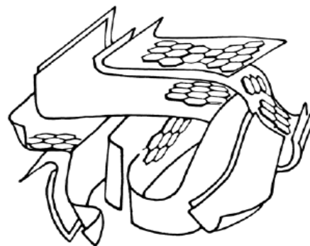
Figure 3 : Représentation de la microstructure d'un charbon actif (Stoeckli, 1991).
