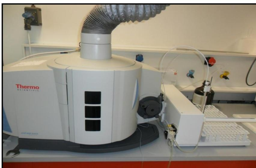
**Figure 9** Photographie d'un ICP-AES ThermoScientifici CAP 6000 series ICP Spectrophotometer
