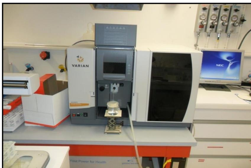
**Figure 8** Photographie d'un spectrophotomètre d'absorption atomique électrothermique (SAAE) (mode flamme).
