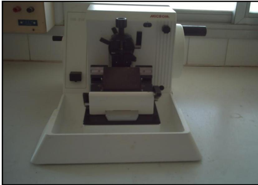
**Figure 11** Photographie du microtome mécanique (type HM 315)
