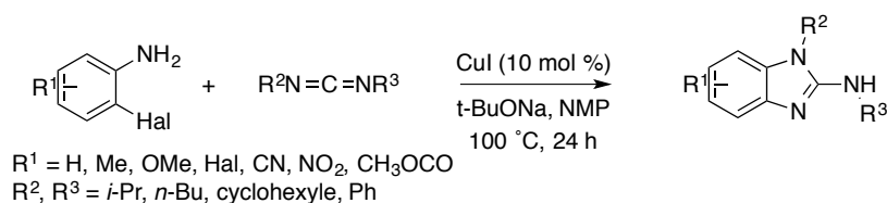
Schéma 2-40. Addition-cyclisation entre des carbodiimides et des o -haloanilines
