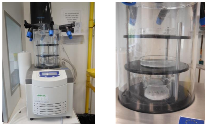
Figure II.9 : photographie du dispositif de lyophilisation
