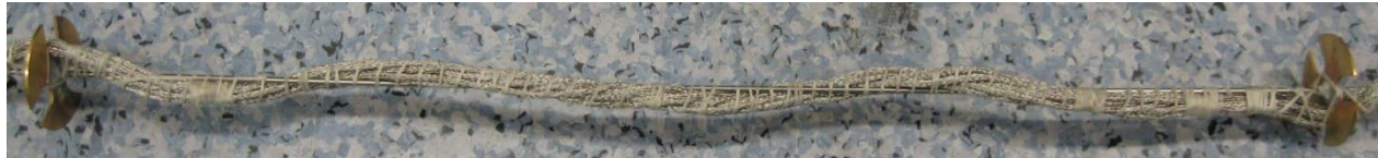
Figure 3-9 : Photographie d'une partie de la tige métallique utilisée comme support des fils d'amenées. Ces derniers sont torsadés entre eux le long de la tige. Ils sont maintenus fermement avec du fil de paraffine. A noter l'orientation relative des disques laitonnés permettant de limiter l'apport d'énergie par rayonnement vers le CCC et le SQUID.
