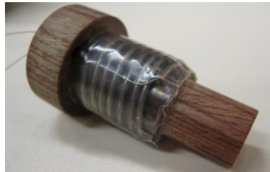
Figure 3-6 : Photographie de la bobine de détection (7 tours) ainsi que son support en Céloron.
