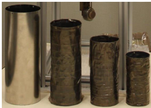
Figure 3-7 : Photographie des blindages ferromagnétique et en plomb. Les deux blindages situés aux extrémités de la photographie sont mis à la masse, les deux autres sont isolés.
