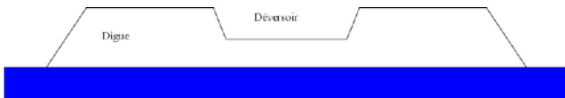
Figure 22 : Représentation schématique d'un déversoir sur une digue
