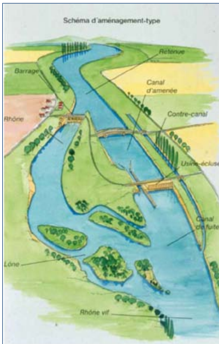
Figure 6 : Aménagement « au fil de l'eau » de la CNR.
