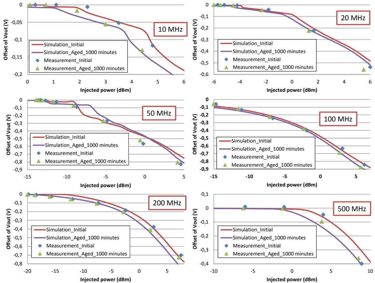
Figure VII-4 Comparaison de l'offset d'un amplificateur entre les simulations et les mesures avant et après le vieillissement à des fréquences différentes
