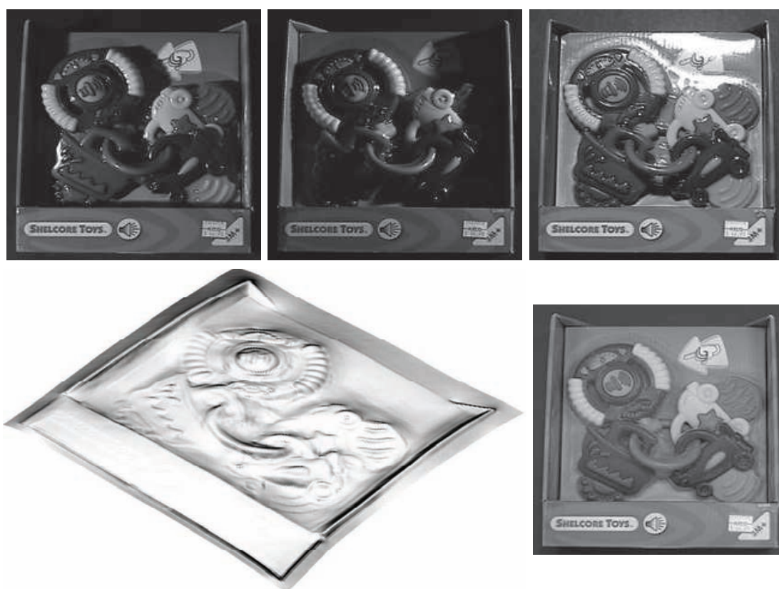
FIGURE 7.8 – Première ligne : trois photographies (parmi m = 27 ), de taille 209 \times 212 , d'une boîte à jouet [273]. Deuxième ligne : relief et albédo estimés par l'approche variationnelle en moindres carrés du paragraphe 7.1.7. Les pentes élevées sont aplaties, les discontinuités sont lissées et l'albédo contient beaucoup d'informations géométriques parasites.
