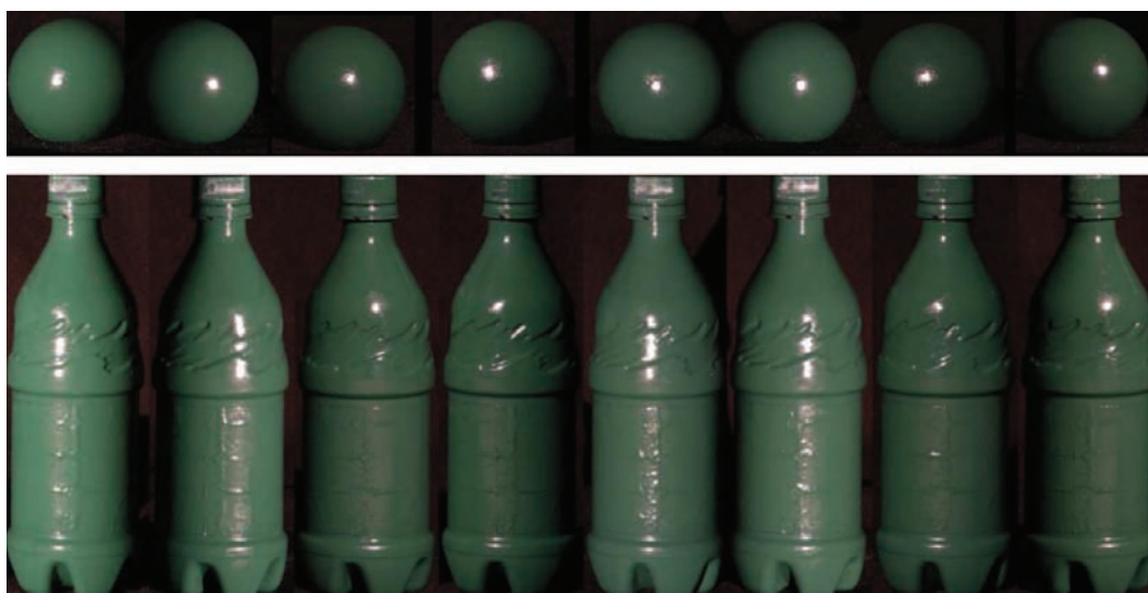
FIGURE 6.5 – Images réelles d'une sphère (de taille 332 \times 328 ) et d'une bouteille (de taille 1176 \times 398 ) vues sous les mêmes m = 8 éclairages, provenant de http://grail.cs.washington.edu/projects/sam/ .
