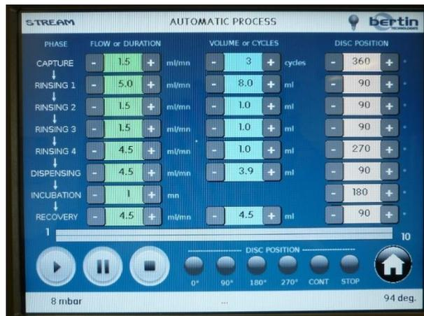
Figure 4-6: Ecran de pilotage du démonstrateur de tri cellulaire. Pour chaque étape il faut définir les paramètres suivants : débit, volume, et position du disque tournant.
