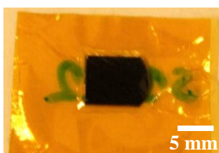
Figure 103 : Exemple d'un échantillon confiné au sein d'un scotch Kapton
