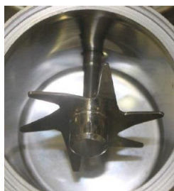
Figure 42 : Hélice à six pales du mélangeur à turbine
