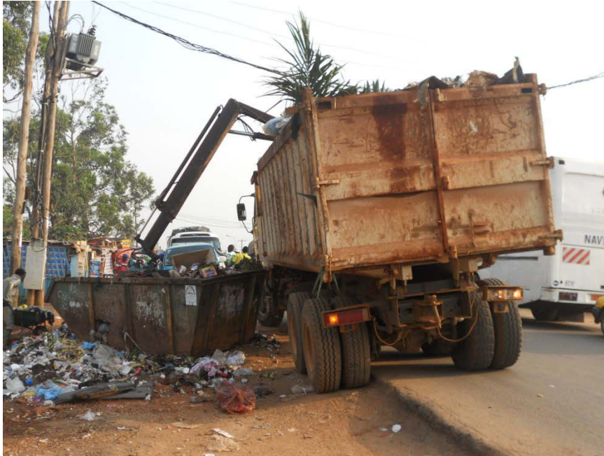
Photo 6 : Vidange d'un bac à Mvan par une grue, Ngambi Jules 2012
