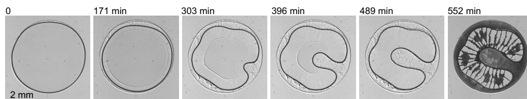
FIGURE 3.3: Série d'images représentant le séchage confiné d'une goutte contenant une dispersion colloïdale de particules de PMMA dans la décaline avec un rayon de 230 nm.
