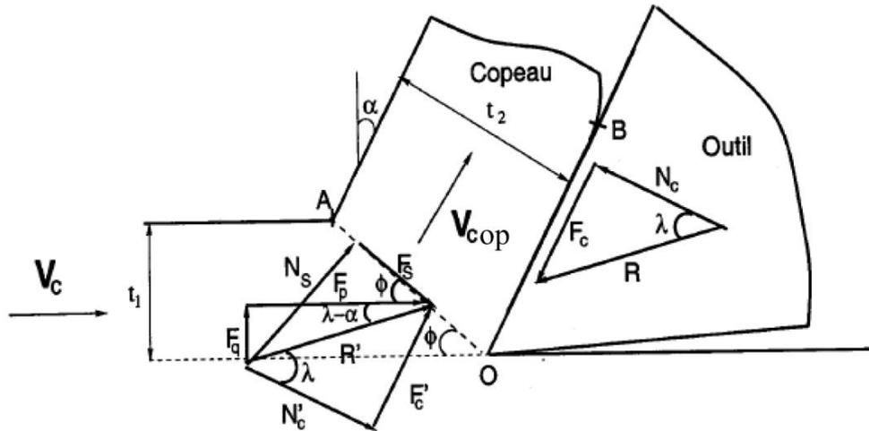
Figure 1-8. Modèle de coupe de Merchant [Nouari, 2000].
