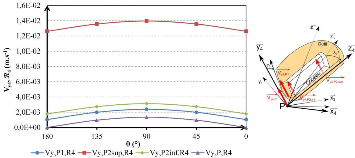
Figure 3-15. Variation instantanée des vitesses  $V_{y_4}$  dans le repère  $\mathcal{R}_4$  (pour les conditions de coupe du Tableau 3-3 et  $\kappa_r = 45^\circ, \gamma_0 = 6^\circ$  et  $\lambda_s = 6^\circ$ ).
