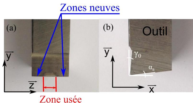
Figure 2-27. Zones usée et neuve sur l'arête de coupe (a) vue de face (b) vue de droite.
