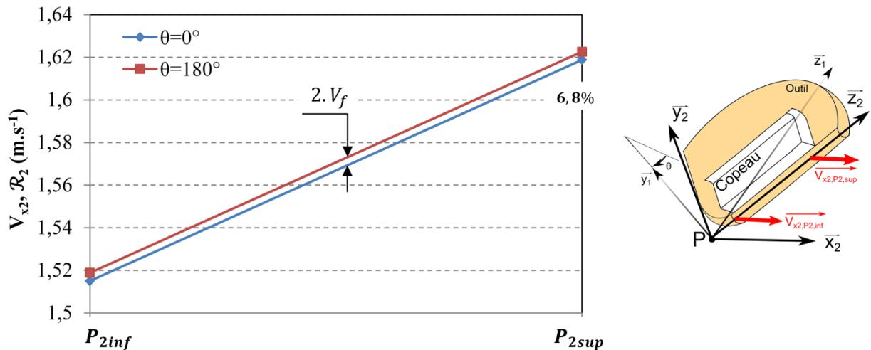
Figure 3-10. Variation instantanée des vitesses  $V_{x2}$  dans le repère  $\mathcal{R}_2$  (pour les conditions de coupe du Tableau 3-3 et  $\kappa_r = 45^\circ, \gamma_0 = 0^\circ$  et  $\lambda_s = 0^\circ$ ).
