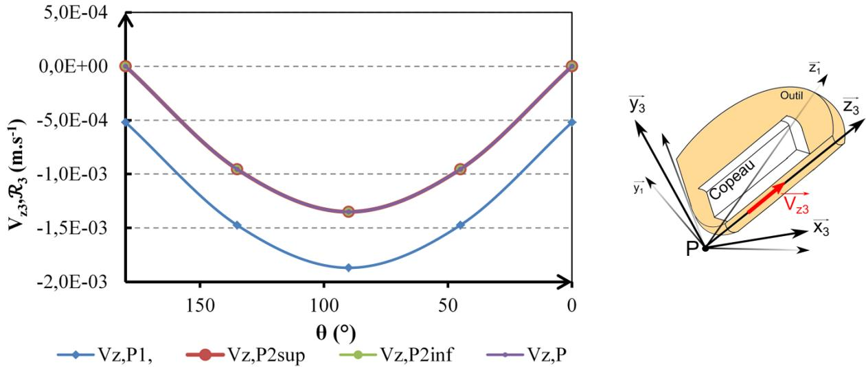
Figure 3-13. Variation instantanée des vitesses  $V_{z3}$  dans le repère  $\mathcal{R}_3$   $\mathcal{R}_2$  (pour les conditions de coupe du Tableau 3-3 et  $\kappa_r = 45^\circ, \gamma_0 = 6^\circ$  et  $\lambda_s = 0^\circ$ ).
