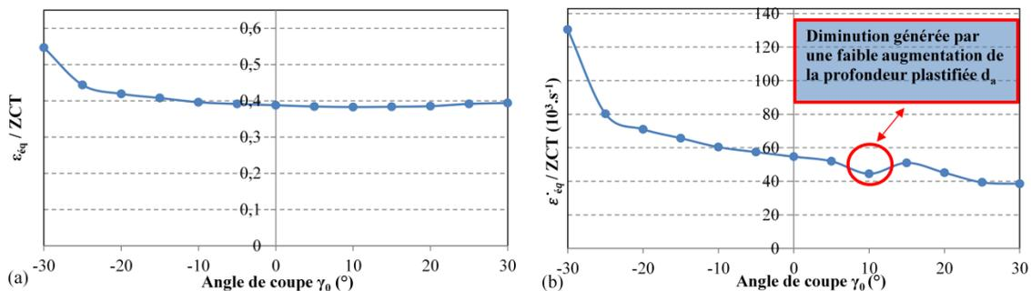
Figure 2-18. (a)Variation de la déformation équivalente et (b) de la vitesse de déformation généralisée au-dessous du point de stagnation en fonction de l’angle de coupe
