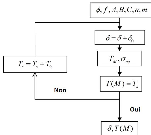
Figure 2- 15. Optimisation de l'épaisseur du cisaillement secondaire
