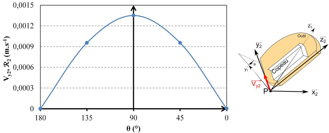
Figure 3-11. Variation instantanée de la vitesses  $V_{y_2}$  dans le repère  $\mathcal{R}_2$  (pour les conditions de coupe du Tableau 3-3 et  $\kappa_r = 45^\circ, \gamma_0 = 0^\circ$  et  $\lambda_s = 0^\circ$ ).
