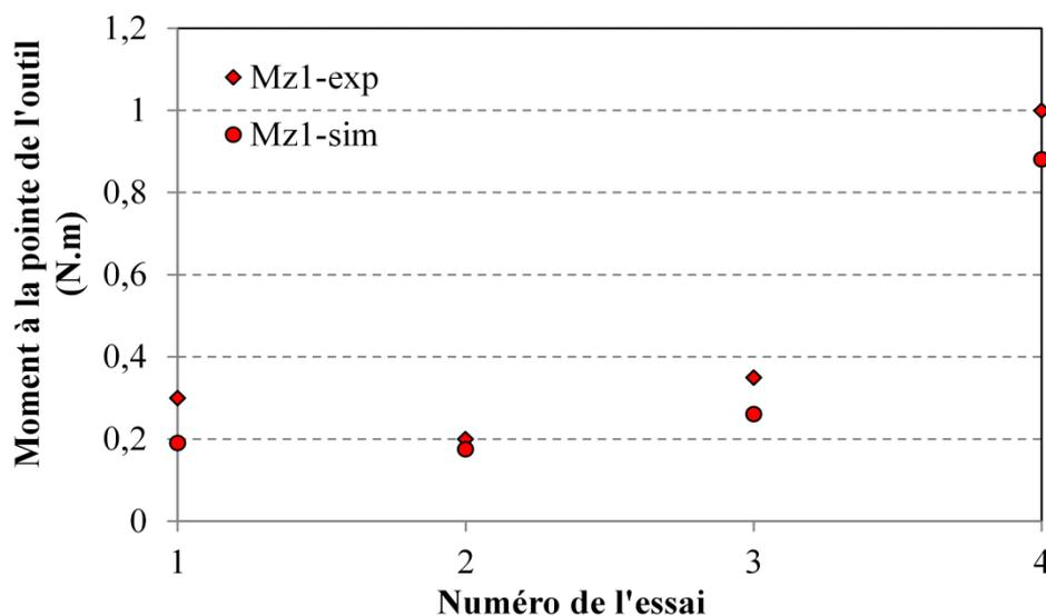
Figure 4-24. Comparaison du moment  $M_{z1}$  : analytique et expérimental.
