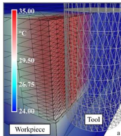
Figure 1-18. Modèle de fraisage [Joliet et al, 2013].
