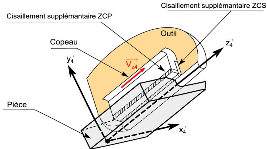
Figure 3-17. Création d'un surplus de déformation dans les deux zones de cisaillement primaire et secondaire dû à la composante de vitesse  $V_{z4}$  de copeau.
