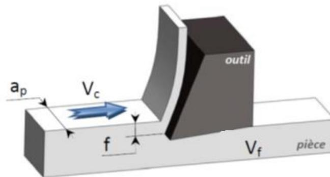
Figure 2-1. Configuration de coupe orthogonale [Albert, 2010].
