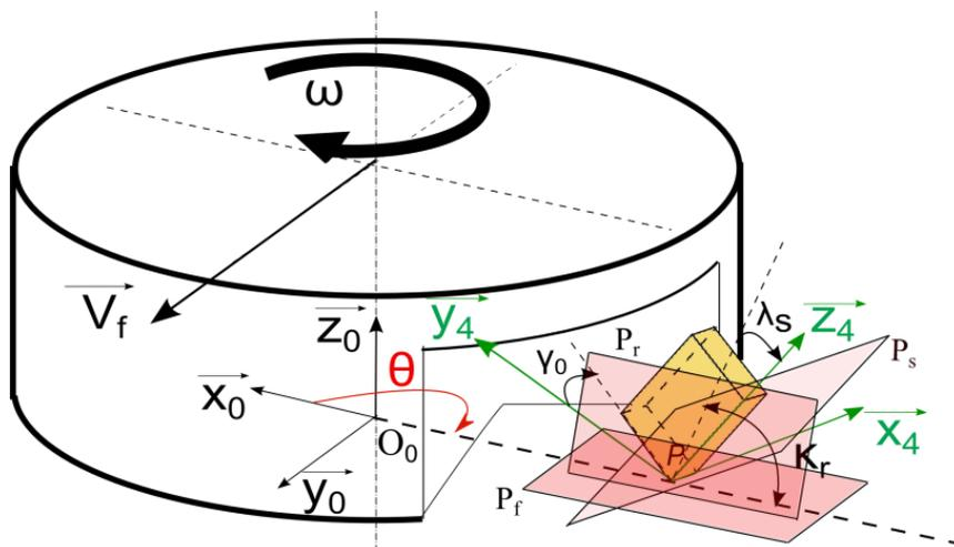
Figure 3-3. Géométrie et paramétrage d'une fraise à plaquette.
