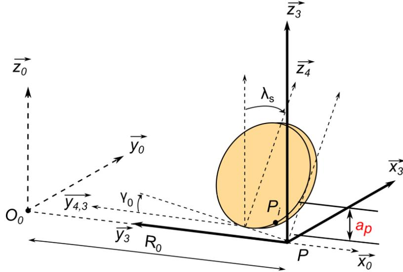
Figure 3-23. Orientation d'une plaquette ronde dans l'espace.
