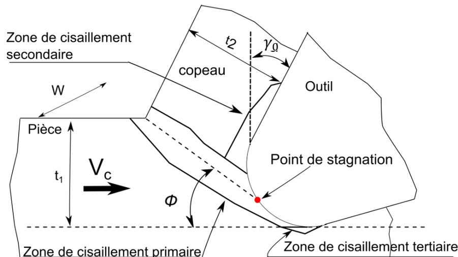
Figure 1-6. Configuration de la coupe orthogonale [Calamaz, 2008].
