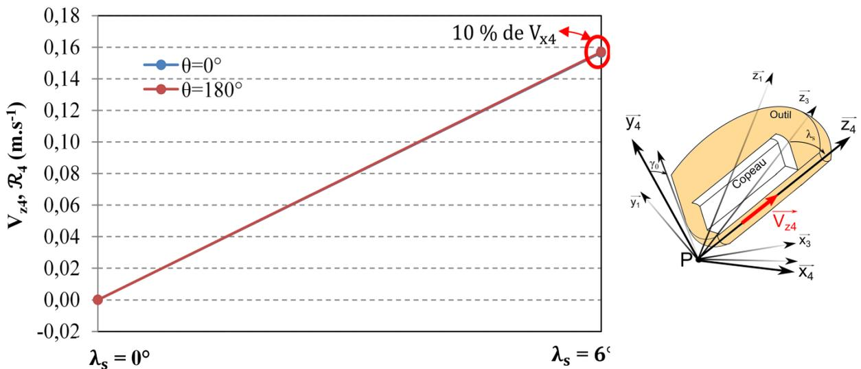
Figure 3-16. Variation instantanée de vitesse  $V_{z_4}$  dans le repère  $\mathcal{R}_4$  pour une variation de  $\lambda_s$  de  $0^\circ$  à  $6^\circ$  (pour les conditions de coupe du Tableau 3-3 et  $\kappa_r = 45^\circ, \gamma_0 = 6^\circ$ ).
