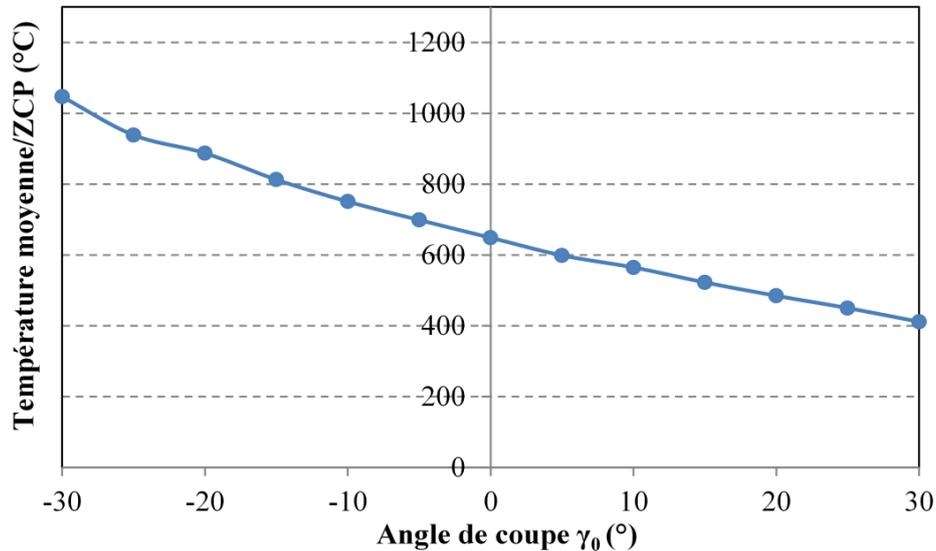
Figure 2-7. Température moyenne dans la ZCP en fonction de l'angle de coupe ( $V_c = 60 \text{ m} \cdot \text{min}^{-1}$ ,  $f = 0,2 \text{ mm}$ ).
