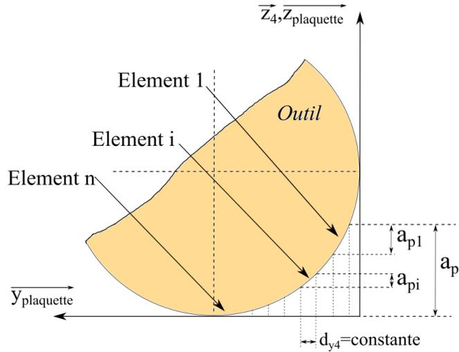
Figure 4-15. Discretisation de l'arête pour une plaquette ronde.
