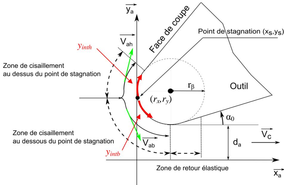
Figure 2-16. Modélisation de la zone de cisaillement tertiaire.
