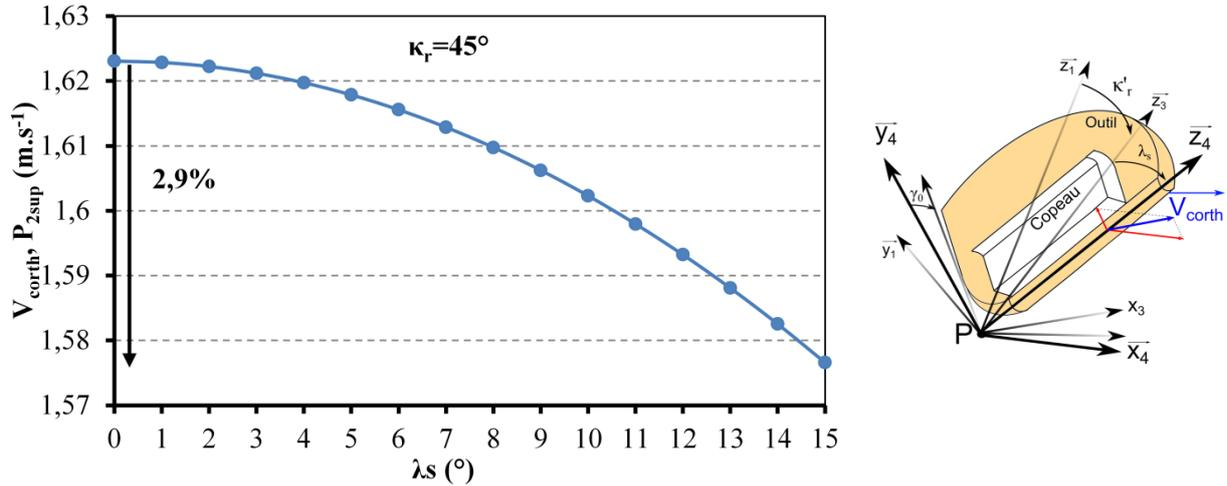
Figure 3-18. Sensibilité de la vitesse de coupe  $V_{corth}$  à l'angle d'inclinaison d'arête (pour les conditions de coupe du Tableau 3-3 et  $\kappa_r = 45^\circ, \gamma_0 = 6^\circ$ ).
