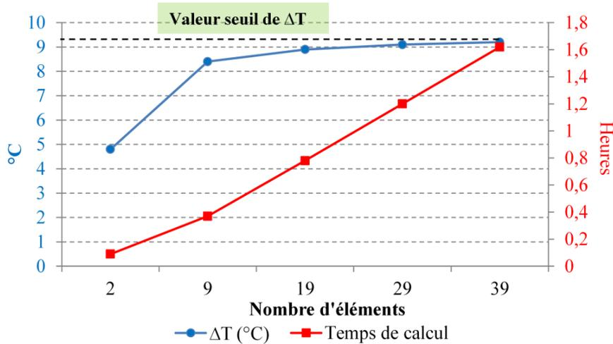
Figure 4-16. Evolution du gradient de température entre les deux points extrêmes de l'arête et le temps de calcul du modèle en fonction du nombre d'éléments.
