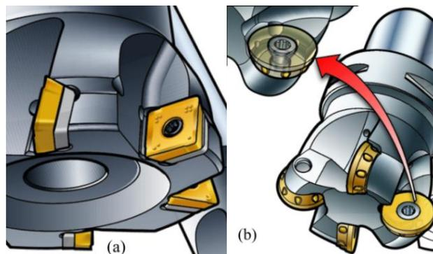
Figure 1-2. (a) Fraise à plaquette avec arête droite, (b) plaquette ronde [SANDVIK-COROMANT, 2001].
