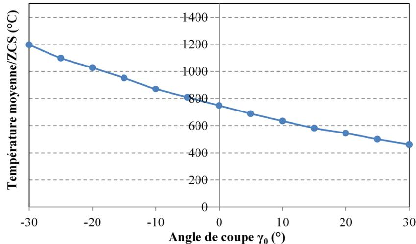
Figure 2-14. Variation de température moyenne en fonction de l'angle de coupe ( $V_c = 60 \text{ m.min}^{-1}, f = 0,2 \text{ mm}$ ).
