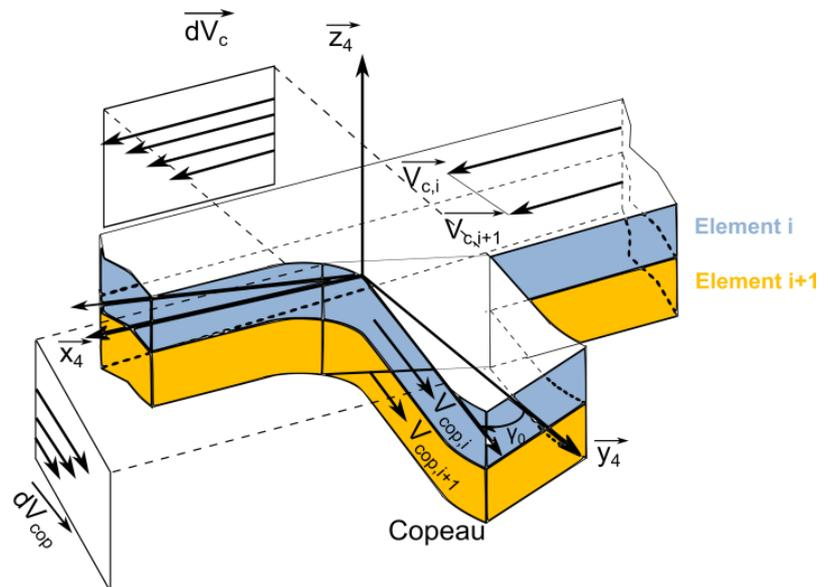
Figure 4-2. Interaction entre l'élément  $i$  et  $i+1$  générée par les gradients de vitesses.
