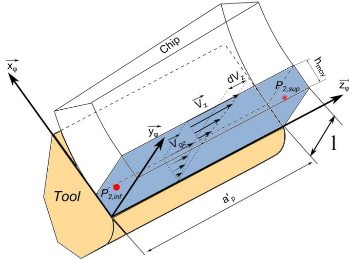
Figure 4-6. Distribution de la vitesse portée par  $\vec{z}_\phi$ .
