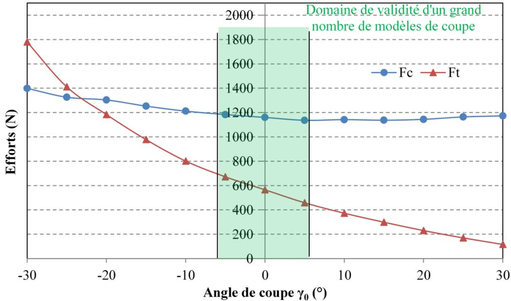
Figure 2-24. Variation de l'effort de coupe et de l'effort tangentiel en fonction de l'angle de coupe ( $v_c = 60 \text{ m} \cdot \text{min}^{-1}$ ,  $f = 0,2 \text{ mm}$ ).
