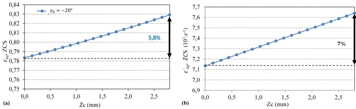
Figure 4-9. Variation de la déformation (a) et de la vitesse de déformation (b) dans la zone de cisaillement secondaire.
