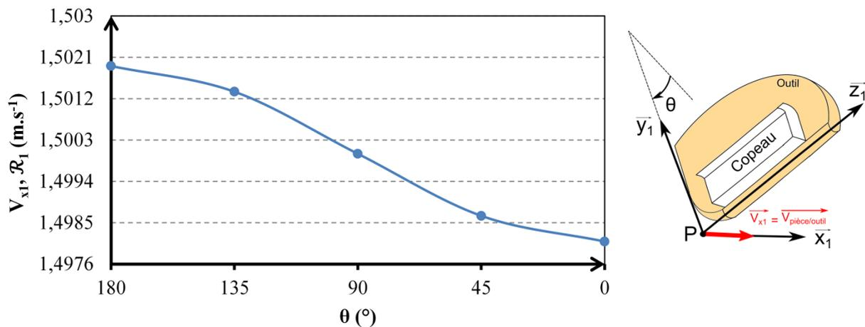
Figure 3-8. Variation de la composante normale à la plaquette portée par  $\bar{x}_1$  au point  $P$  (pour les conditions de coupe du Tableau 3-3 et  $\kappa_r = 90^\circ, \gamma_0 = 0^\circ$  et  $\lambda_s = 0^\circ$ ).
