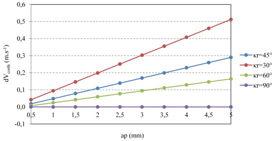
Figure 4-4. Variation de la différence de vitesse de coupe entre les deux points extrêmes ( $dV_{corth}$ ) de la partie linéaire de l'arête de coupe en fonction de la profondeur de passe et l'angle de direction d'arête. ( $V_c = 90m.min^{-1}$ ,  $\lambda_s = \gamma_0 = 6^\circ$ ).
