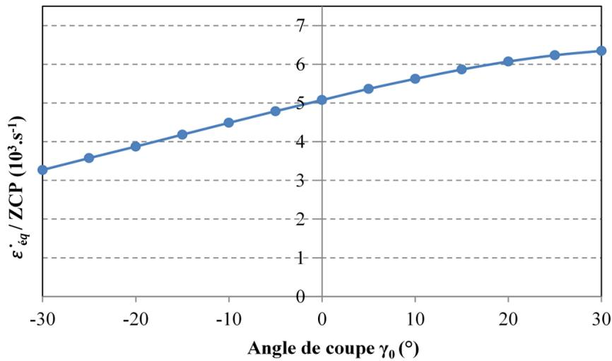
Figure 2-5. Évolution de la vitesse de déformation équivalente en fonction de l'angle de coupe ( $V_c = 60 \text{ m} \cdot \text{min}^{-1}$ ,  $f = 0,2 \text{ mm}$ ).
