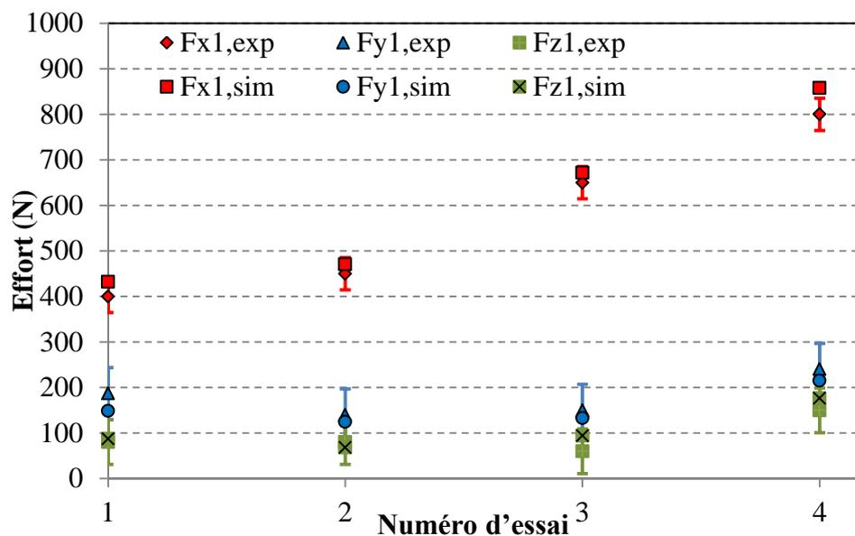
Figure 4-23. Comparaison des efforts analytiques et expérimentaux.
