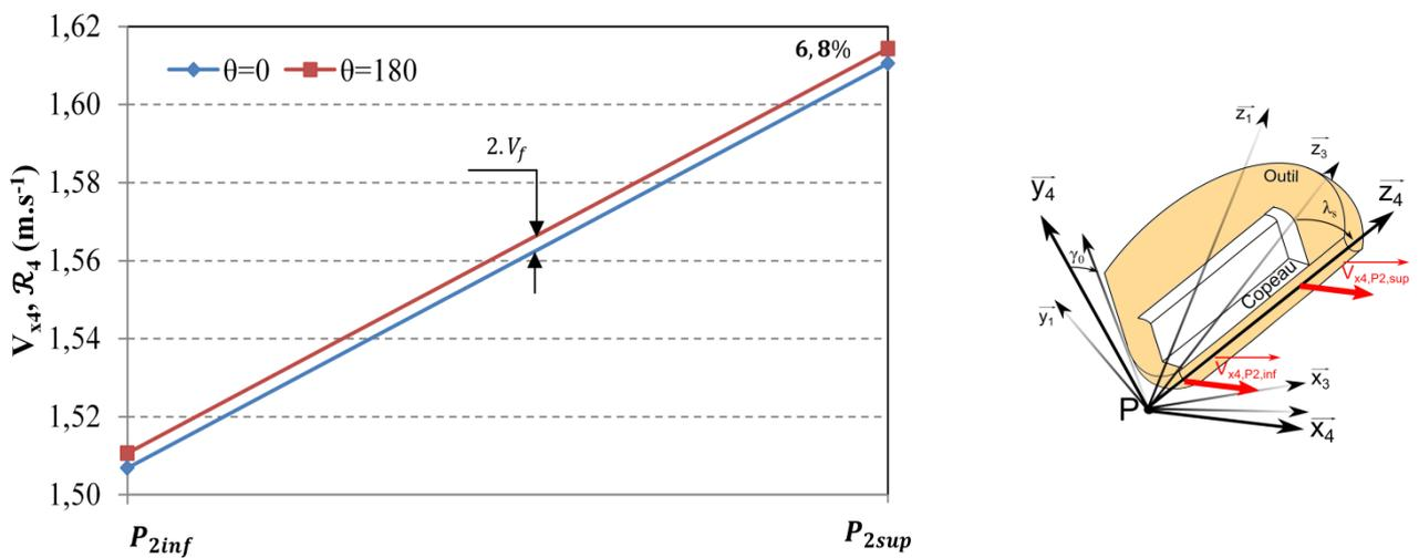
Figure 3-14. Variation instantanée des vitesses  $V_{x4}$  dans le repère  $\mathcal{R}_4$  (pour les conditions de coupe du Tableau 3-3 et  $\kappa_r = 45^\circ, \gamma_0 = 6^\circ$  et  $\lambda_s = 6^\circ$ ).
