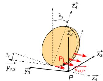
Figure 3-24. Variation de la composante  $V_{x_4}$  dans le repère  $\mathcal{R}_4$  le long du rayon de bec ( $\gamma_0 = \lambda_s = 6^\circ$ ).
