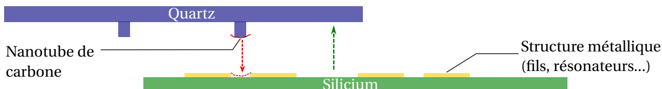
FIGURE 2.2 – Schéma présentant le principe du tamponnage de nanotube de carbone - le substrat de silicium est apposé au contact du pilier de quartz (flèche verte) - le nanotube est reporté lors du contact sur le substrat de silicium (flèche rouge)
