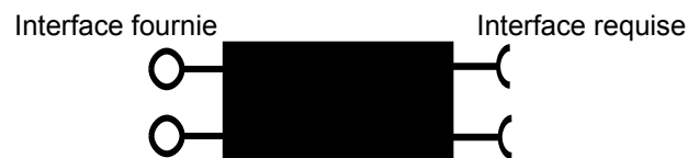
Figure 1.3 — Représentation graphique des interfaces requises et fournies d'un composant
