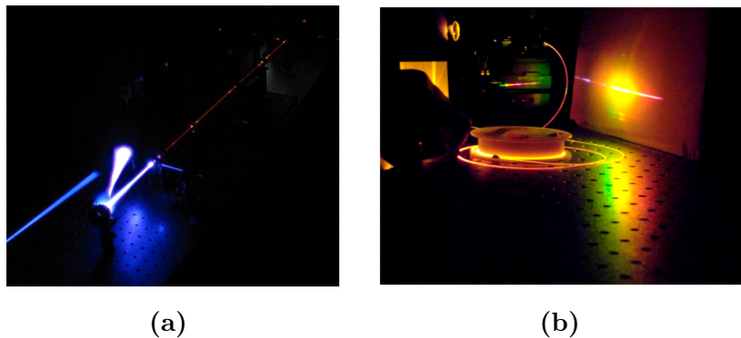
Figure I – Observations de phénomènes optiques nonlinéaires. (a) Génération de deuxième harmonique. Un faisceau lumineuse rouge, à fréquence \omega , est transmis à travers un matériau qui convertit une partie des photons incidents à la fréquence 2\omega (violet) [2]. (b) Première observation de la génération de supercontinuum dans une fibre optique structurée [3]. L'interaction entre plusieurs phénomènes nonlinéaires et la dispersion du guide élargit le spectre d'un signal sur plusieurs octaves en couvrant tout le spectre visible [4].
