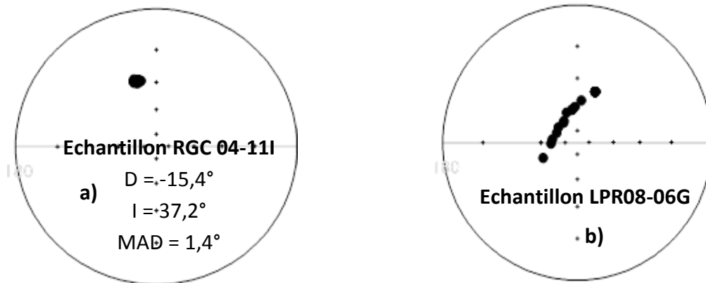
Figure III.25 : Stéréogrammes des échantillons RGC 04-111 pour lequel la ChRM est obtenue par analyse en composante principale (a), et LPR 08-06G pour lequel il est impossible d'obtenir la ChRM et dont la direction de NRM suit un grand cercle (b).
