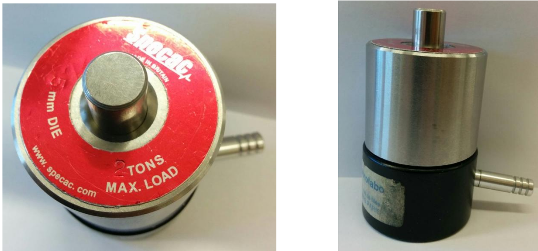
Figure 7 : Matrice de pastilleuse ( \varnothing = 5 \text{ mm} ) utilisée à l'IMMM.
