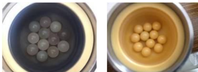
Figure 30 : Photographies des jarres et billes de broyage, en agate ( \text{SiO}_2 -gauche) et en zircone ( \text{ZrO}_2 -droite).
