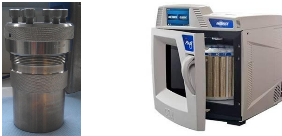
Figure 27 : Exemples d'une bombe Parr (gauche) et d'un four micro-ondes (droite) de type MARS (société CEM). À l'intérieur sont installés les réacteurs en téflon, chemisés par du kevlar tressé.
