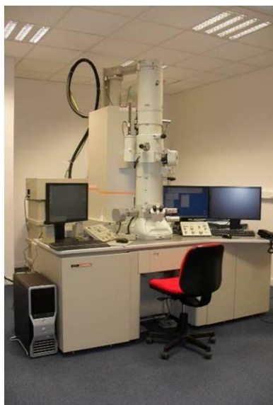
Figure 15 : Photographie du MET de l'IMMM (à gauche) - Schéma de la colonne d'un MET (à droite)
