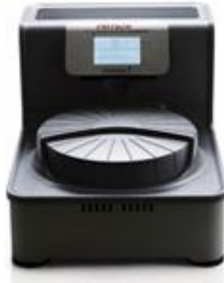
Figure 14 : Broyeur planétaire Pulvérisette 7 premium line.
