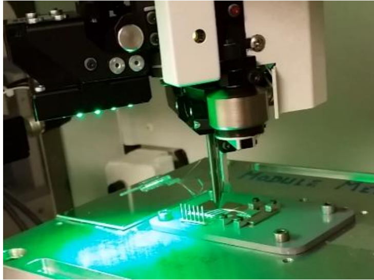
Fig. II-16 : Câblage des fils par Wire Bonder
