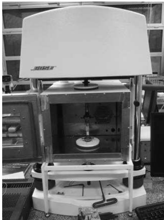
FIG. B.1: Photo du DMA du laboratoire Femto-st
