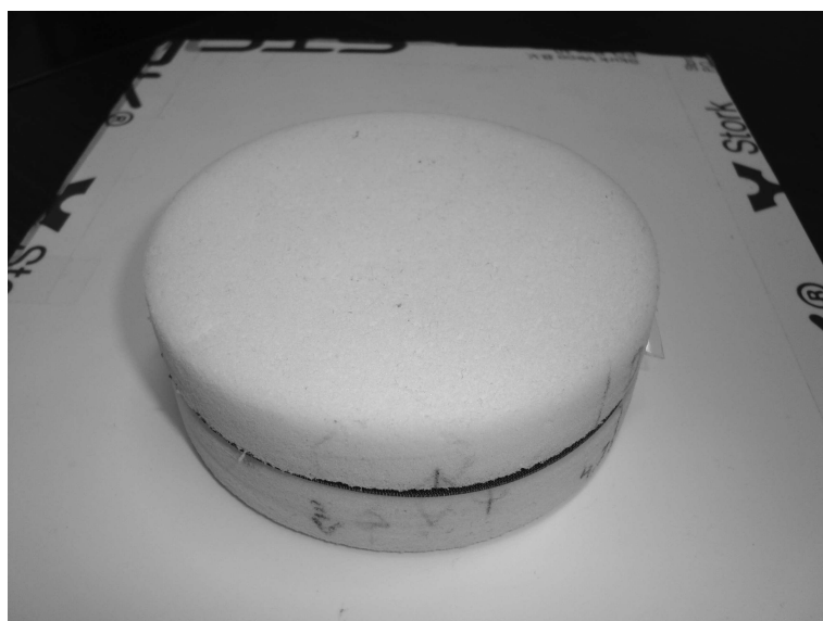
FIG. 3.20: Sandwiche structure micro-structurées (P) plus mousse mélamine (M)
