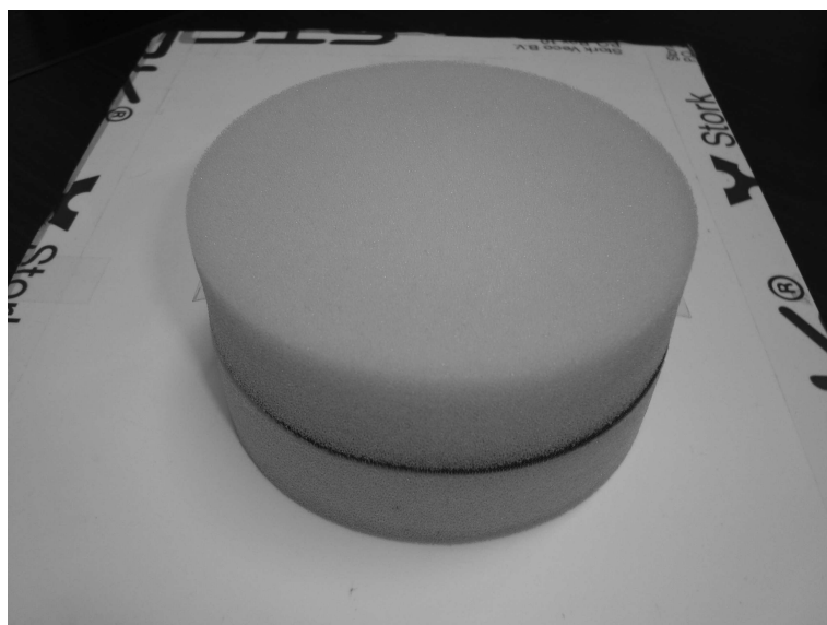
FIG. 3.19: Sandwich structure micro-structurées (P) plus mousse fournie avec mousse "Kundt" (K)
