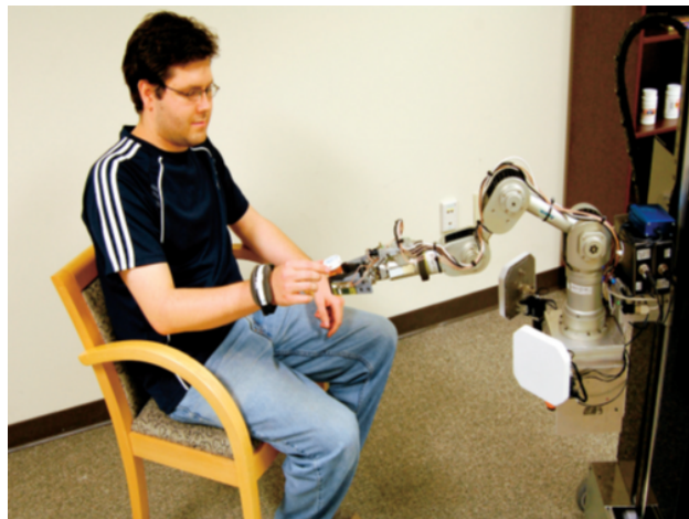
FIGURE 2.1 – Robot EL-E, équipé d'un lecteur d'étiquettes RFID UHF, remettant une boîte de médicaments munie d'une étiquette RFID à une personne portant un bracelet équipé d'une étiquette (tag) RFID [8].
