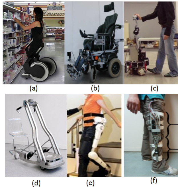
FIGURE 2.5 – Robots d’assistance à la mobilité : (a) CARRIER (b) Sharioto (c) iCane (d) RobuWalker (e) Hal (f)EiCOSI.
