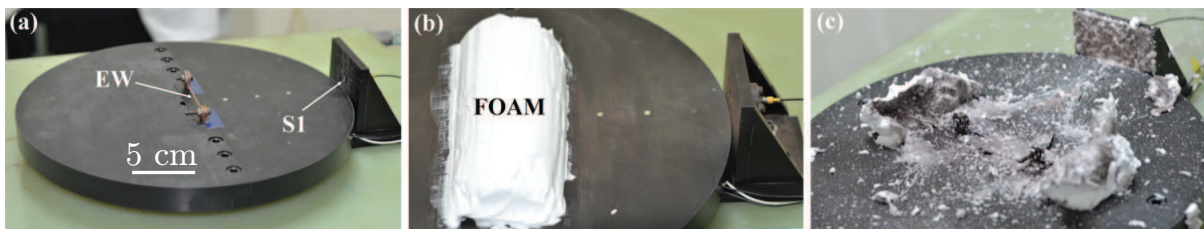
Figure 2.11 – Dispositif expérimental utilisé dans [Liverts et al. , 2015]. (a) Fil de cuivre générateur d'onde de souffle (EW sur la figure) attaché à deux électrodes. Un capteur de pression S1 est installé pour enregistrer le signal de pression au passage de l'onde. (b) Barrière semi-cylindrique de mousse recouvrant le fil. (c) Photo prise après le passage de l'onde de souffle.
