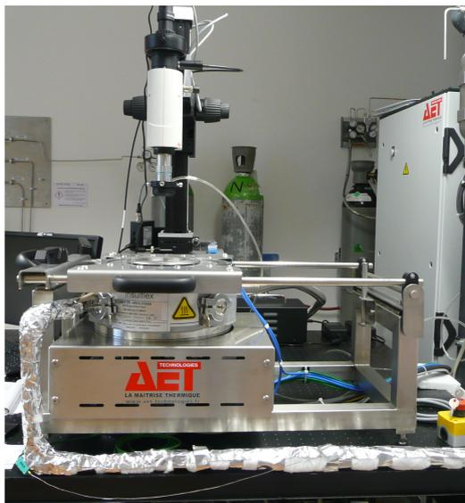
**Figure A.3** – Vue de l'enceinte thermique du système d'oxydation avec le système optique positionné au dessus. L'arrivée de gaz a lieu par le tuyau recouvert d'isolant thermique et d'aluminium au premier plan, l'évacuation se fait par le côté opposé, non visible sur ce cliché.
