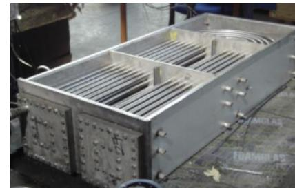
Figure II-20 : a) Configuration des différents tests réalisés et b) vue de l'échangeur utilisé par G. Peiro *et al.* [73] pour montrer l'efficacité d'une association de MCP en cascade dans un système de stockage latent
