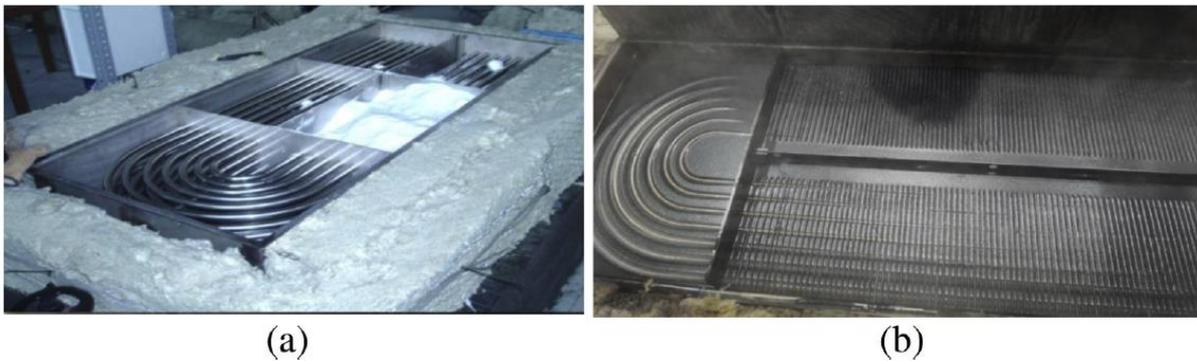
**Figure II-55 : Géométries d'échangeur testées dans l'installation de stockage de l'université de Lleida [109]**
