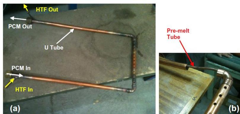
Figure II-26 : Echangeur avec recirculation du MCP dans des tubes en U à double enveloppe imaginé par N.H.S. Tay *et al.* [82]
