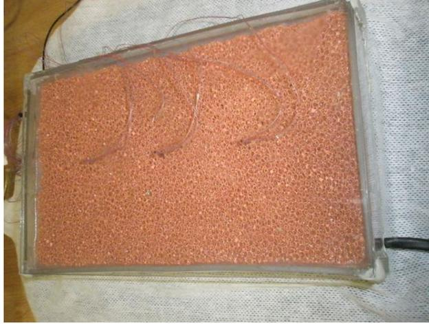
Figure II-14 : Mousse de cuivre à imprégner de MCP [56]
