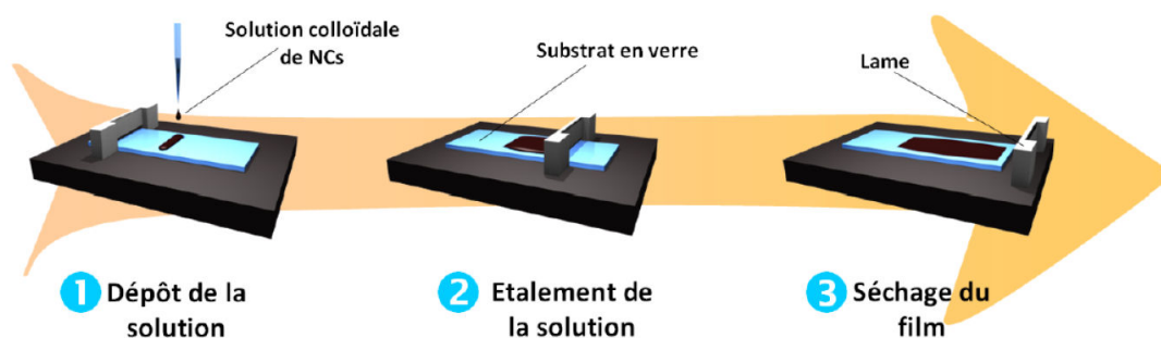
FIGURE 2.4: Procédé de doctor blading [76]
