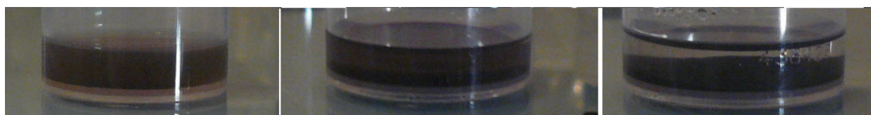
FIGURE 5.4: Décantation des nanoparticules dans l'eau au cours du temps
