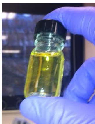
FIGURE 4.26: Solution de chlorure d'étain (IV) complexé par l'éthylène diamine
