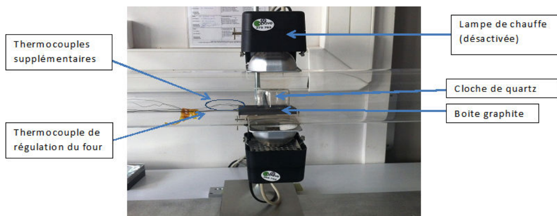
FIGURE 3.14: Dispositif de recuit sous atmosphère de soufre
