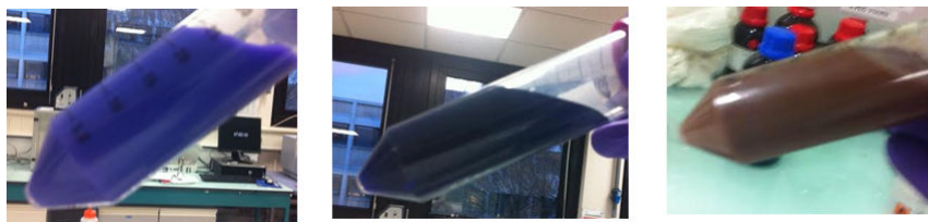
FIGURE 4.27: Solutions de précurseurs avant introduction de la source de soufre (gauche), la même solution en excès d'éthylène diamine (milieu) et la solution après introduction de la source de soufre (droite)
