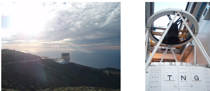
FIGURE 4.1 – Photographies du TNG, extérieure et intérieure (monture alt-azimutale).
