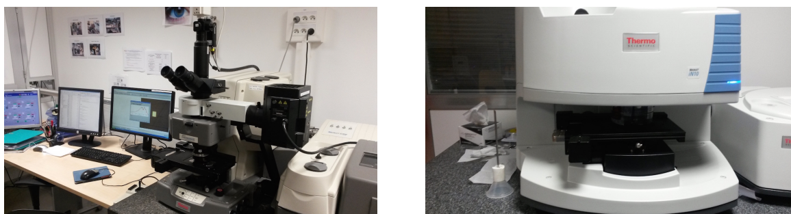
FIGURE 7.5 – Les instruments de micro-spectroscopie IR à SOLEIL. – À GAUCHE : Microscope NicPlan (au centre) couplé au spectromètre IRTF (à droite) fonctionnant avec la source synchrotron ou la source interne, avec écrans de contrôle (à gauche). – À DROITE : Spectro-microscope iN10, fonctionnant uniquement avec sa source interne.
