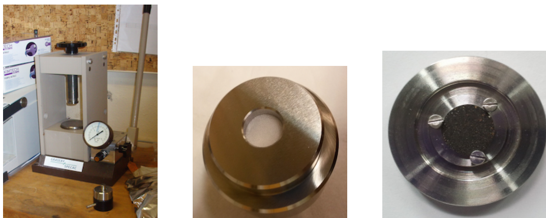
FIGURE 7.12 – À GAUCHE : Presse manuelle avec le moule à pastiller au premier plan. – AU CENTRE : Couche de KBr ayant subi une première pression pour aplanir la surface sur laquelle ajouter la poudre d’échantillon. Une pression d’environ 7 T pendant 6 min est alors appliquée pour solidariser les deux couches. – À DROITE : Pastille finale obtenue (ici Murchison) sur un porte-échantillon. Les pastilles font 13 mm de diamètre.
