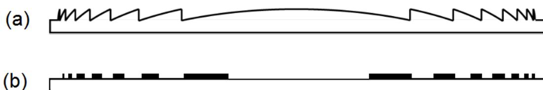
**Figure 2.55** – (a) Lentille de Fresnel. (b) Réseau zoné. Extrait de [103].
