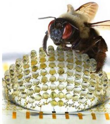
**Figure 2.30** – Illustration de la caméra visible multivoie bio-inspirée développée par une équipe de recherche de l'Université de l'Illinois [61]. Elle est basée sur l'utilisation d'une matrice de lentilles et une matrice de détecteurs toutes les deux déformées sur un support sphérique convexe ( $R=6,96\text{mm}$ ).
