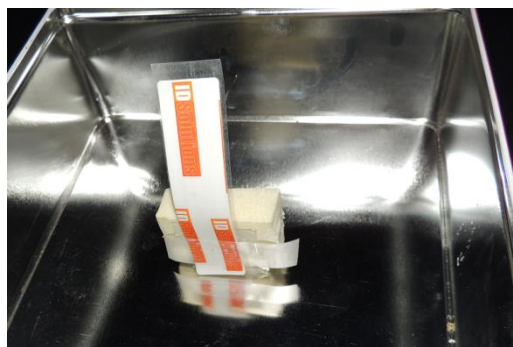
Figure 3.18. Tag dipôle couplé électriquement à l'ACRF.
