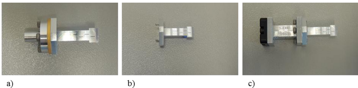
Figure 5.19. Antenne GORF et les différentes charges appliquées pour la caractérisation de la SER. a) Court-circuit avec espaceur. b) Guide ouvert. c) Charge adaptée.
