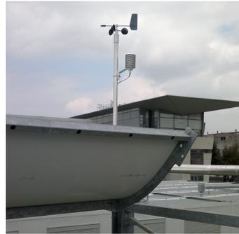
(b) Anémomètre, capteur de température extérieure
