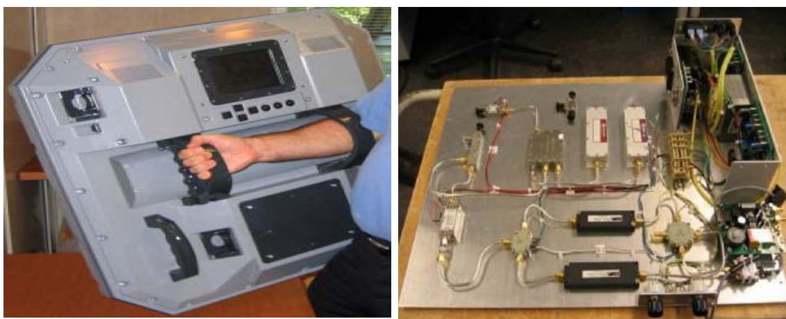
Figure B.3 : (à gauche) : la maquette du système radar PROBANT. (à droite) : la carte électronique du système [Zhug et al. 07].
