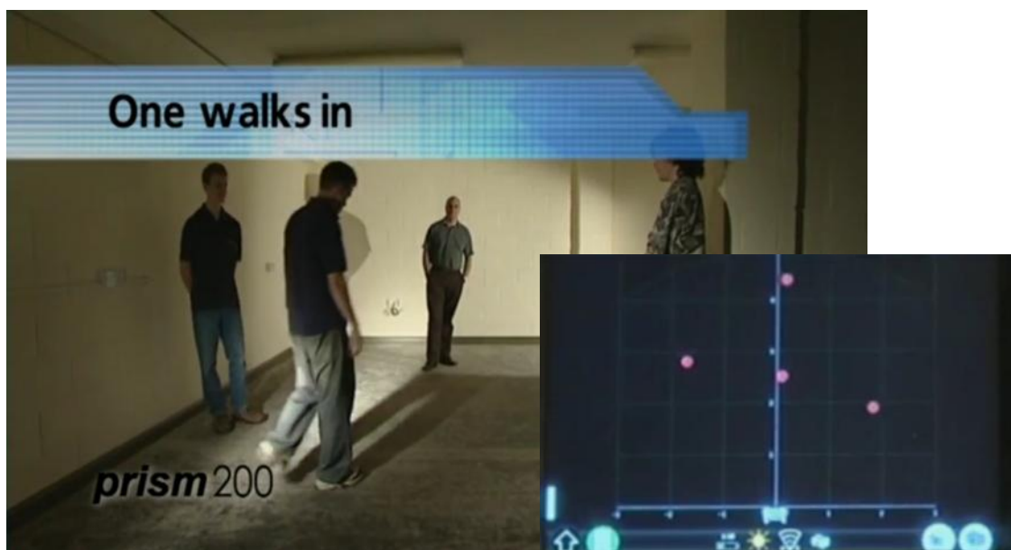
Figure B.12 : test du système PRISM200®. Résultat de la détection de quatre cibles humaines (dont une cible mobile) dans une salle [Prism 14].
