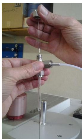
Figure 4. 4. Montage du pyrolyseur à point de Curie
