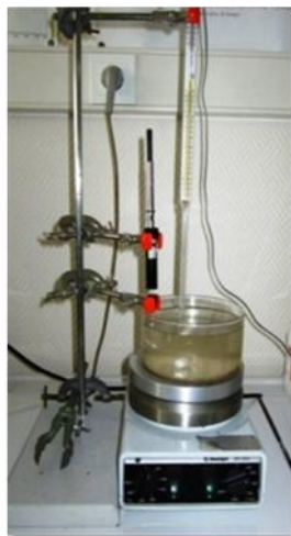
Figure 4. 3. Montage de la microextraction sur phase solide en espace de tête (Hs-SPME)
