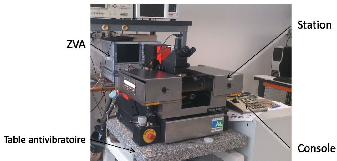
Figure 6 : Banc de mesure de paramètres S dans la gamme [0,1-67GHz]
