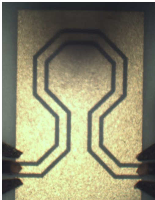
Figure 68 : Photographie de la ligne courbe de 2,83mm avec une distance inter-pointes de 800\mu\text{m} réalisée au laboratoire
