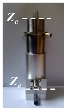
Figure 4.5 Applicateur tête-bêche B et emplacement des plans d'entrée et de sortie.
