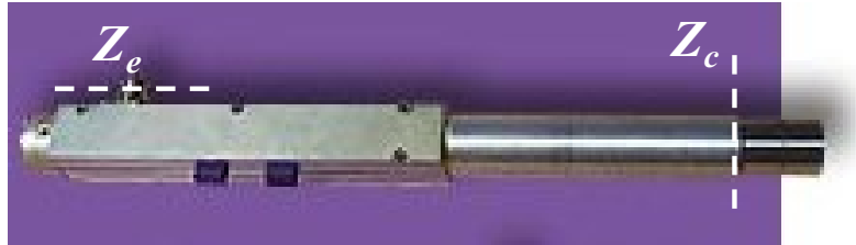
Figure 4.6 Applicateur tête-bêche B et emplacement des plans d'entrée et de sortie.
