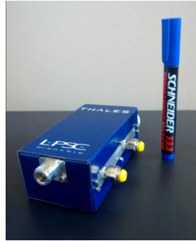
Figure 5.4 Générateur prototype Thales 2,45 GHz / 50W.
