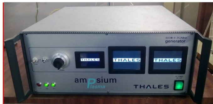
Figure 4.36 Générateur 352 MHz de fabrication Thales Electron Devices.
