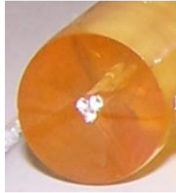
Figure 3-4. Photo d'une préforme percée de TZN fabriquée au laboratoire.
