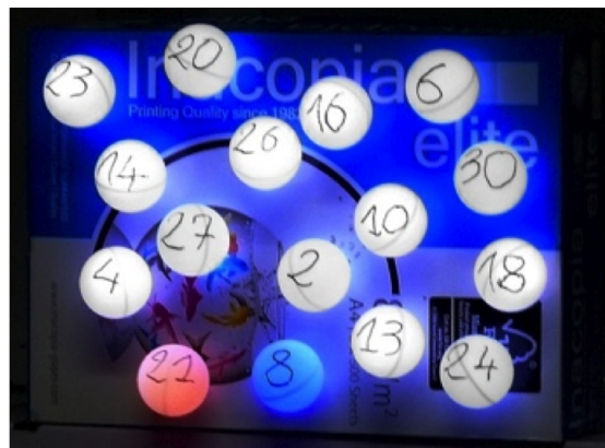
FIGURE 5.8 – Plateau avec 16 objets physiques (balles de ping-pong) intégrant des LEDs. La numéro 21 (rouge) représente la cible de l'essai en cours, la numéro 8 (bleue) représente l'élément sélectionné courant.
