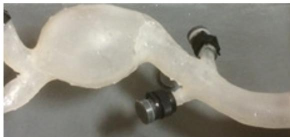
Figure VI.2 : Réplique réaliste d'AAA utilisée lors des essais.
