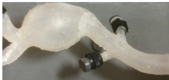
Figure VI.2 : Réplique réaliste d'AAA utilisée lors des essais.
