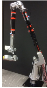
Figure V.1 : Bras de mesure Romer et capteur laser associé.
