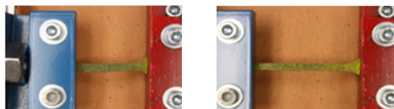
Figure V.5 : Eprouvette en silicone soumise à un essai de traction.
