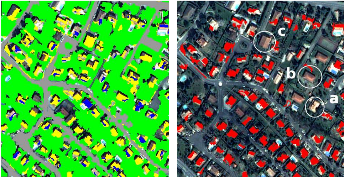
(a) En bleu et jaune, les deux concepts appris par la méthode. La végétation en vert, les routes en gris
